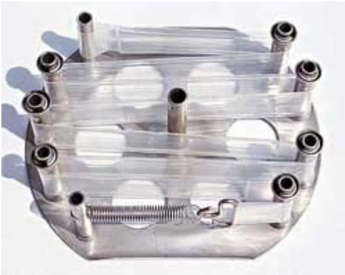
Figura 1 SPMD montata su supporto metallico (spider) in fase di campionamento
