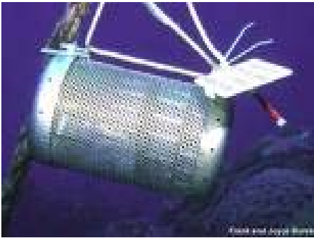
Figura 3 Gabbia in acciaio per la protezione di membrane semipermeabili durante i campionamenti in ambiente marino (fonte: Environmental Sampling Technologies Inc)
